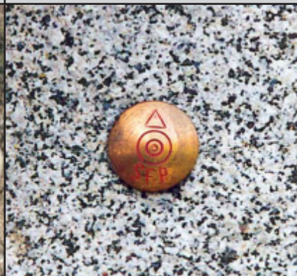
SFP Messingbolzen Ø 3 cm
