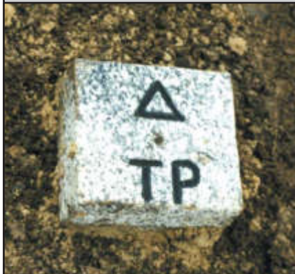
BFP/TP Granitpfeiler 16 cm x 16 cm (auch bodengleich)*
