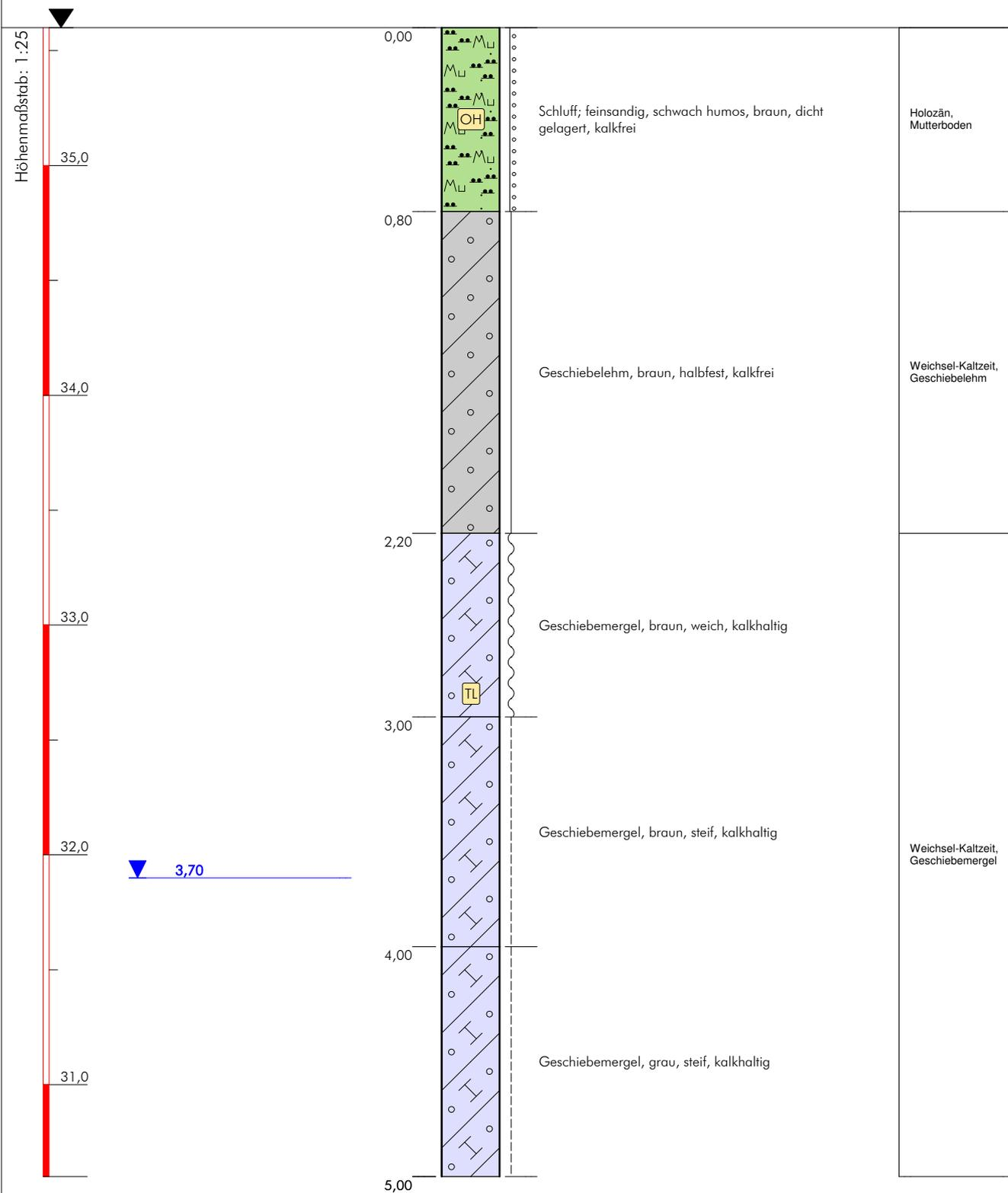
Hinweis: Die im Profil dargestellten Wasserspiegel sind zeitbezogen und keine Bemessungswasserspiegel !
